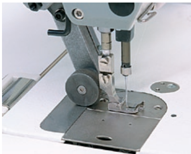
Puller mit Standard Nähfuß und Adapter
