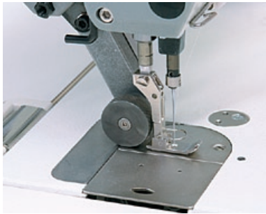
Puller mit angepasstem Fuß (geschlossen)
