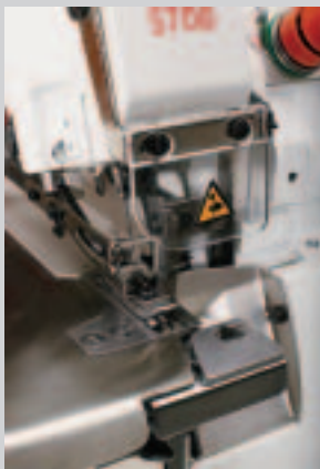
Manuelle Nahtanfangsverriegelung mit Spannungslüftung Manual backlatching with tension release
