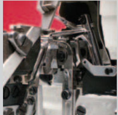
Mitgehender Nadelschutz Needle guard
