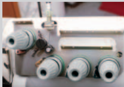
Manuelle Nahtanfangsverriegelung mit Spannungslüftung Manual backlatching with tension release
