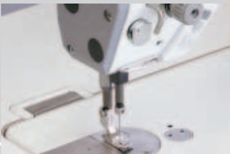
Die neue gesteuerte Fadenklemme -909/14 sorgt stets für einen sauberen Nahtanfang auf der Oberseite des Nähgutes
