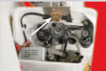
Spulenfadenüberwachung mit Resterkennung -926/06 (Option)
