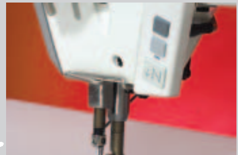
Neuer Dreifachttaster im Greifraum der Näherin: - Vorwärts/Rückwärts - Nadelhoch ohne Schneiden - Riegelaktivierung/ -invertierung - Einfädeltaste
