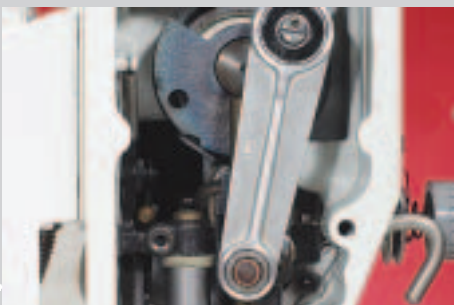
Eine Maschine für dickes und dünnes Material: Nadelstangenhub umstellbar
