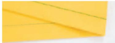
Ein-Nadel-Zwei-Faden-Doppel-Kettenstich zum Bändeinfassen, zum Zusammennähen gewebter Stoffe und für dekorative Effekte.
